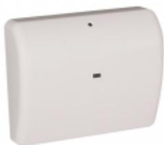
Извещатель предназначен для обнаружения разрушения обычного стекла марок М4-М8 по ГОСТ 111-90 и покрытого защитной полимерной пленкой, обеспечивающей класс защиты А1-А3 по РД 78.148-94 МВД России, стекол толщиной от 2,5 до 8,0 мм площадью не менее 0,1 м<sup>2</sup> (при длине каждой из сторон не менее 0,3 м). Применяется с контроллером "С2000-КДЛ" или "С2000-КДЛ-2И".
