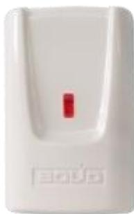
Извещатель предназначен для обнаружения попытки преднамеренного разрушения (взлома) бетонных стен и перекрытий толщиной не менее 0,12 м, кирпичных стен толщиной не менее 0,15 м, деревянных конструкций толщиной материала от 20 до 40 мм, фанеры толщиной не менее 4 мм, конструкций из древесностружечных плит толщиной не менее 15 мм, типовых металлических сейфов, шкафов, дверей и банкоматов. Применяется с контроллером «С2000-КДЛ».
