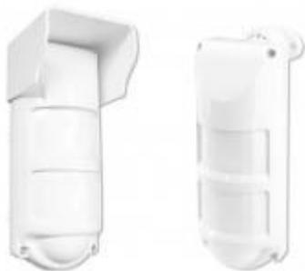
Извещатель охранный поверхностный оптико-электронный адресный с защитой от животных до 20 кг. Предназначен для работы, как в закрытых помещениях, так и на открытых площадках на периметре объекта. Форма обнаружения типа "штора". Применяется совместно с контроллером "С2000-КДЛ" или "С2000-КДЛ-2И".
