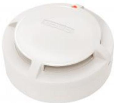
Извещатель пожарный газотепловой адресно-аналоговый "С2000-ИПГ" предназначен для контроля состояния и обнаружения возгораний, сопровождающихся выделением угарного газа (СО), а также тепла. Совмещает в себе пороговый газовый и максимально-дифференциальный тепловой (класс А1R) пожарных извещателей. Выдает извещения "Пожар", "Неисправность", "Тест". Применяется с контроллером "С2000-КДЛ" и "С2000-КДЛ-2И".
