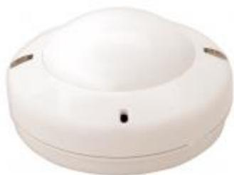
Предназначен для обнаружения разрушения стекол толщиной от 2,5 до 8 мм и проникновения (попытки проникновения) в охраняемое пространство закрытого помещения. В одном корпусе совмещены ИК-извещатель "С2000-ПИК" и извещатель звуковой "С2000-СТ". Устанавливается на потолке помещения. Применяется с контроллером "С2000-КДЛ" и "С2000-КДЛ-2И"
