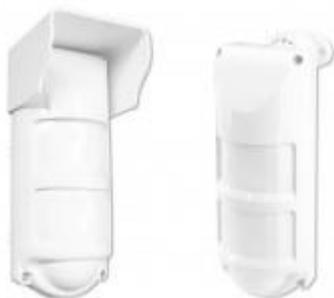
Извещатель охранный объемный оптико-электронный адресный с защитой от животных до 20 кг. Предназначен для работы, как в закрытых помещениях, так и на открытых площадках на периметре объекта. Применяется совместно с контроллером "С2000-КДЛ" или "С2000-КДЛ-2И".
