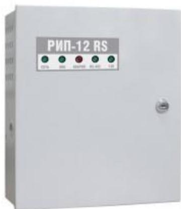
"РИП-12 RS" предназначен для работы в составе ИСО "Орион" для питания извещателей, приборов ОПС, СКУД и пожарной автоматики. Соответствует Техническому регламенту и сертифицирован по ГОСТ Р 53325-2009. В ИСО "Орион" "РИП-12 RS" взаимодействует с пультом "С2000М" или АРМ "Орион Про", передает данные и получает команды управления по интерфейсу RS-485.
